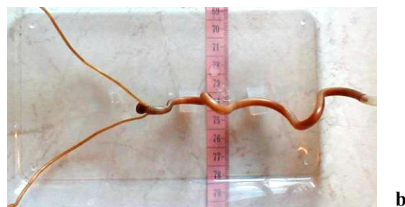
1 pav. M2 modelio eskizas (a); sukurtas modelis M2 (b): nulipdyta vaškinė atlieja
